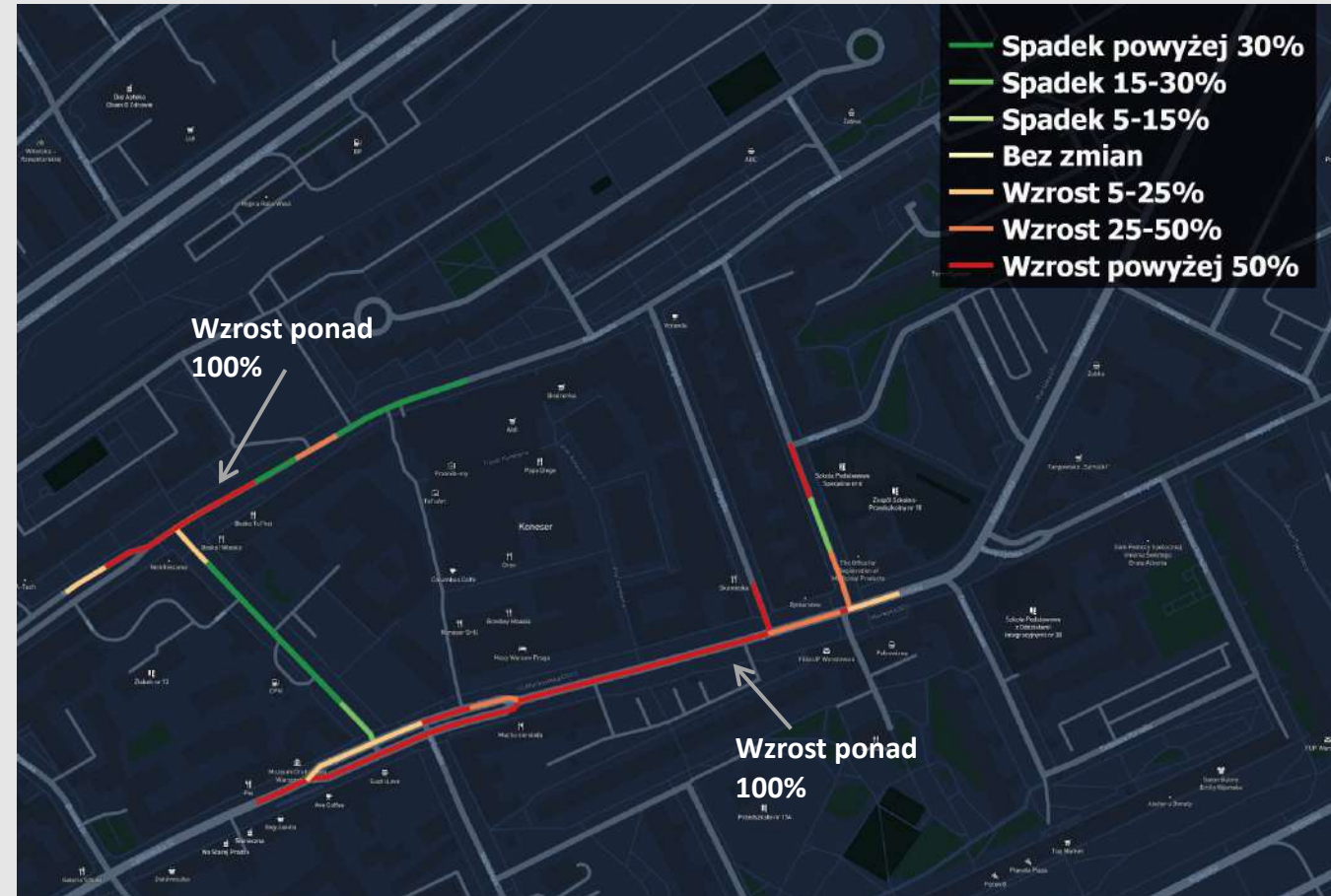
Stosunek ruchu pieszego w okresie II do okresu I Źródło: opracowane na podstawie danych CitiesAI
